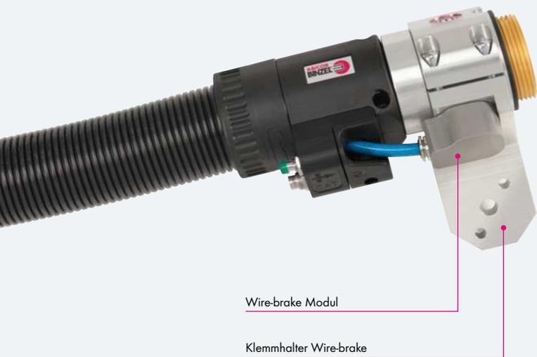
Für die taktile Bauteilsuche mittels Schweißdraht sind die bewährten ABIROB® W Schlauchpakete optional mit einer Drahtklemmfunktion (Wire-brake) zur Fixierung des Drahtes im Schlauchpaket erhältlich. Diese Funktion ermöglicht es, den Draht im Schlauchpaket zu arretieren, indem er über einen druckluftbetriebenen Kolben gegen ein Widerlager gepresst und so gegen das Verschieben gesichert wird.
