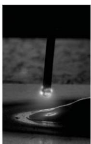
Reinigung und Vorwärmung des Drahtes in der negativen Phase
